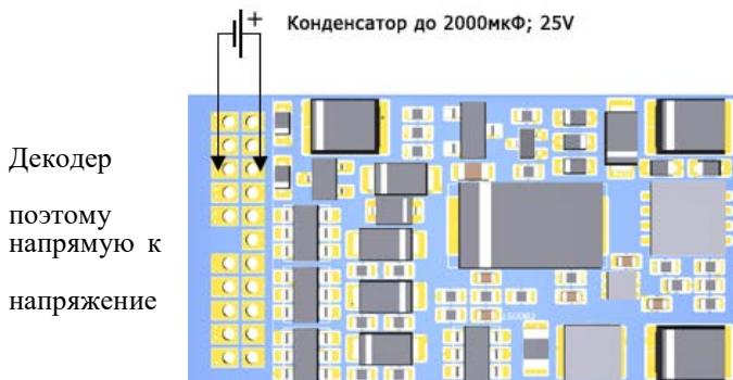
LGR2-P22 (также, как и SoundGT2.1) имеет встроенный ограничитель тока и напряжения заряда конденсатора, конденсатор емкостью до 2000мкФ можно подключать контактам «GND» и «Конденсатор +». При этом можно использовать конденсатор, рассчитанный на 16В. Даже если на рельсах выше 16В.
